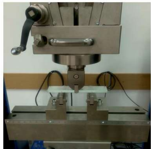
Ryc.2. Instalacja testowa: a) schemat ideowy instalacji (gdzie, 1 - prototyp, 2 - rolka gnąca, 3 - rolki nośne, 4 - uszczelki gumowe, l_s - odległość między rolkami nośnymi); b) ogólny widok instalacji.
