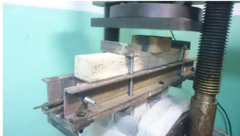
Рис.1. Виготовлення елемента ущільненням бетонної суміші на пресі
